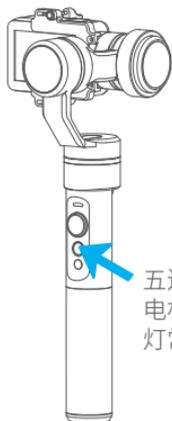
五连击功能键，“滴”声后电机停止工作，蓝色指示灯常亮。
