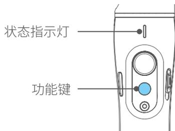
(2) 将稳定器静置于桌面上，待稳定器自动检测到静止后，自动进行初始化，蓝色指示灯由常亮变为周期性三闪时，则初始化成功。
