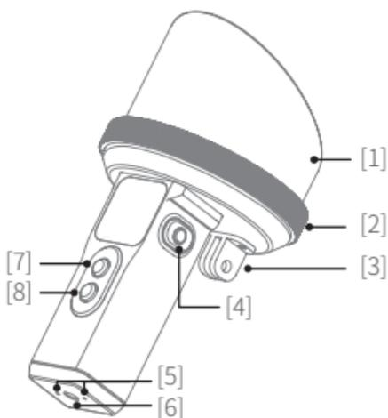
\*转接头[3]可手动拆卸安装到螺纹孔[5]位置
