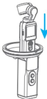
**(3)安装防水罩：**将紧锁紧套入防水罩，卡入防水壳手柄卡口，**拧紧锁紧环**。
