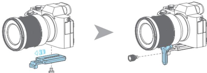
如相机无内置 1/4-20 英寸螺丝孔位，需置入对应的转接组件，再按以上方式安装。
