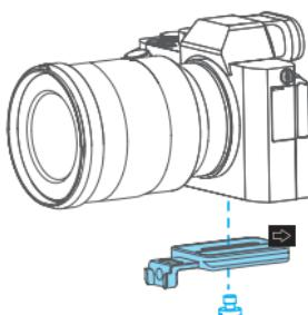
如相机无内置 1/4-20 英寸螺丝孔位，需置入对应的转接组件，再按以上方式安装。
