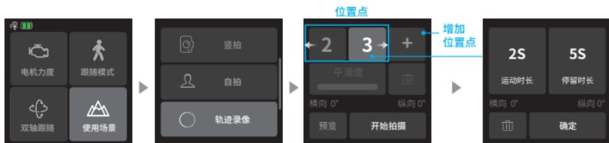
使用摇杆杆或手动扳动俯仰轴 / 航向轴到指定的角度，点击“+”记录当前位置为位置点，以此方式增加下一个位置点，最多支持记录10个位置点。
